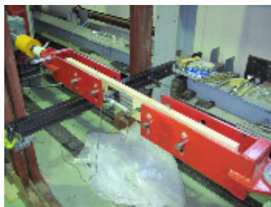
接合部強度試験状況
