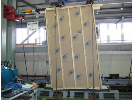
写真 7.1.3 破壊後の様子(千鳥継ぎ-1) 変形角 1/15\text{rad} 時
