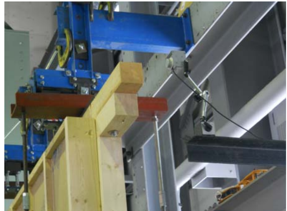
写真 7.1.2 試験体設置状況
