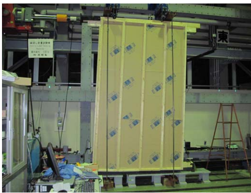
写真 7.1.5 破壊後の様子(千鳥継ぎ-2) 変形角 1/30\text{rad} 時
