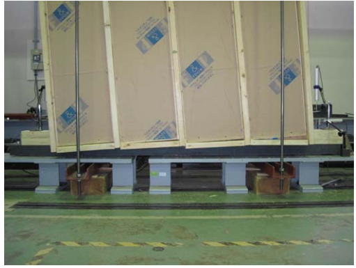
写真 7.1.14 破壊後の様子(一丁継ぎ-3) パネルの変形
