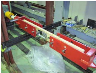
接合部強度試験状況
