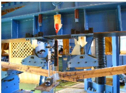
写真3 曲げ試験の様子
