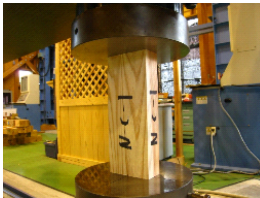
写真5 縦圧縮試験の様子
