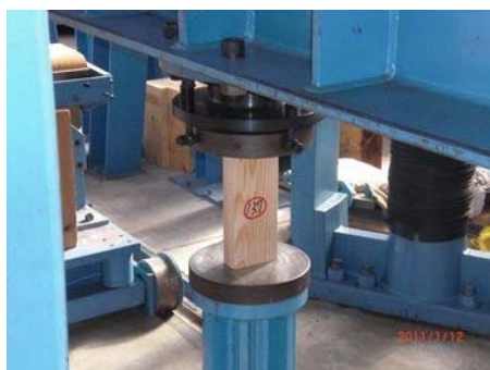
写真 2 2 圧縮強度試験
