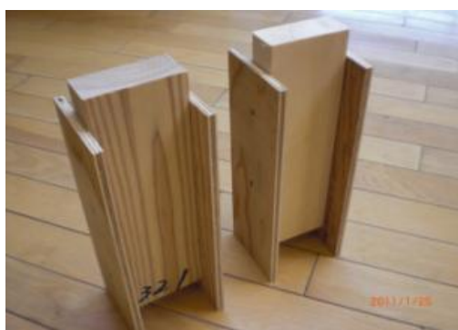
写真 2 6 二面せん断試験片
