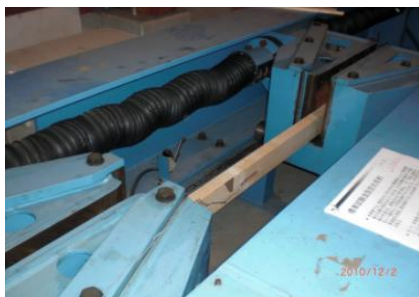
写真 2 1 引張り強度試験
