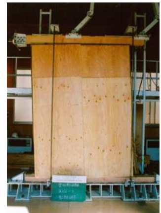
面内せん断試験後 (スギ ACQ)
