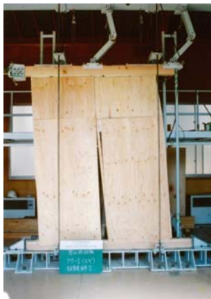
面内せん断試験後 (スギ)
