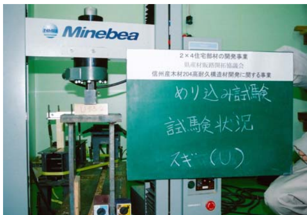
めり込み試験状況（スギ）
