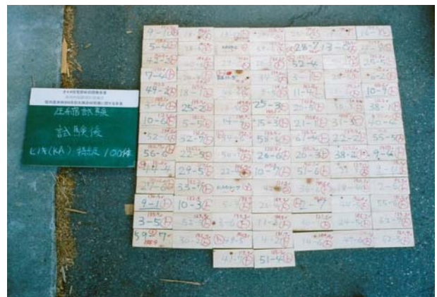
圧縮試験後試験体（ヒノキ）
