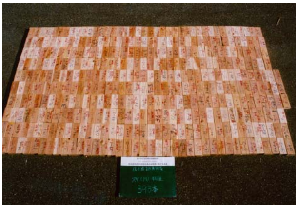
圧縮試験後試験体（スギ）
