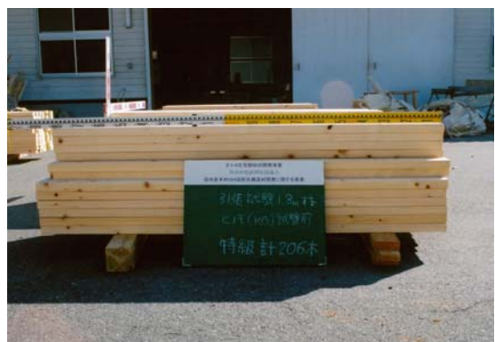
試験前引張り試験体（ヒノキ）
