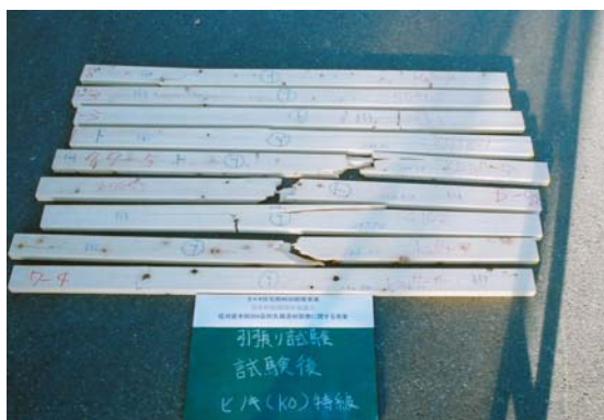
試験後引張り試験体（ヒノキ）
