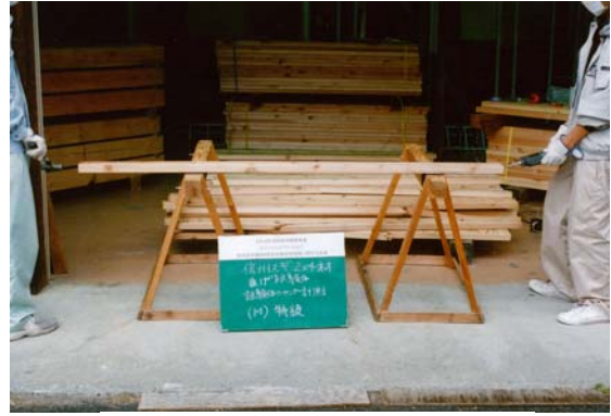
非破壊強度試験 (スギ)
