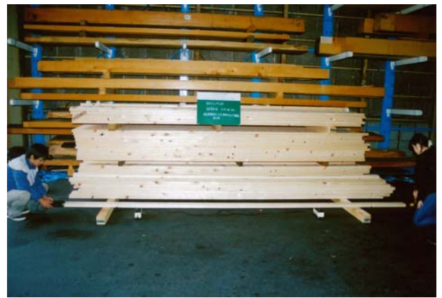
たて振動法非破壊試験状況
